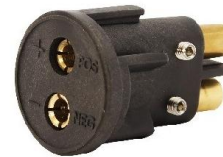
Accesorio de enchufe con terminales desalineados
