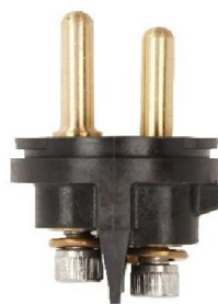
Accesorio de receptáculo con terminales desalineados
