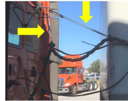
Ressort de maintien à gauche et Ressort de travail à droite
