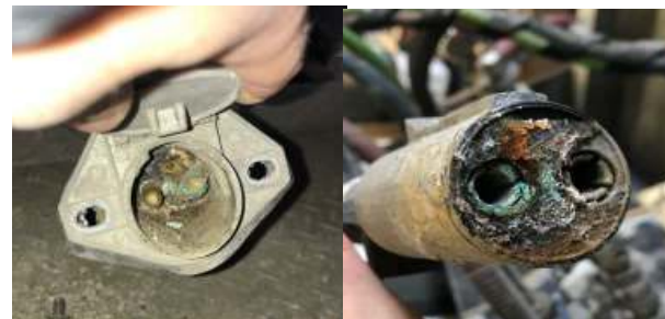
Corrosión del receptáculo bipolar
