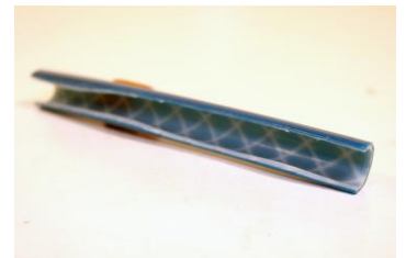
Tubería de aire tipo B de doble pared con trenzado interno
