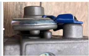
El tope de la mano de acople estándar de emergencia no gira más allá del tope de la mano de acople en ángulo de servicio
