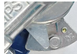
El brazo de servicio no puede girar más allá del tope de emergencia
