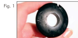
Sello de la manita libre agrietado/desgastado
