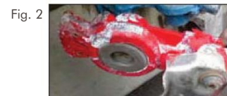
Hay corrosión donde se desprendió el recubrimiento de polvo
